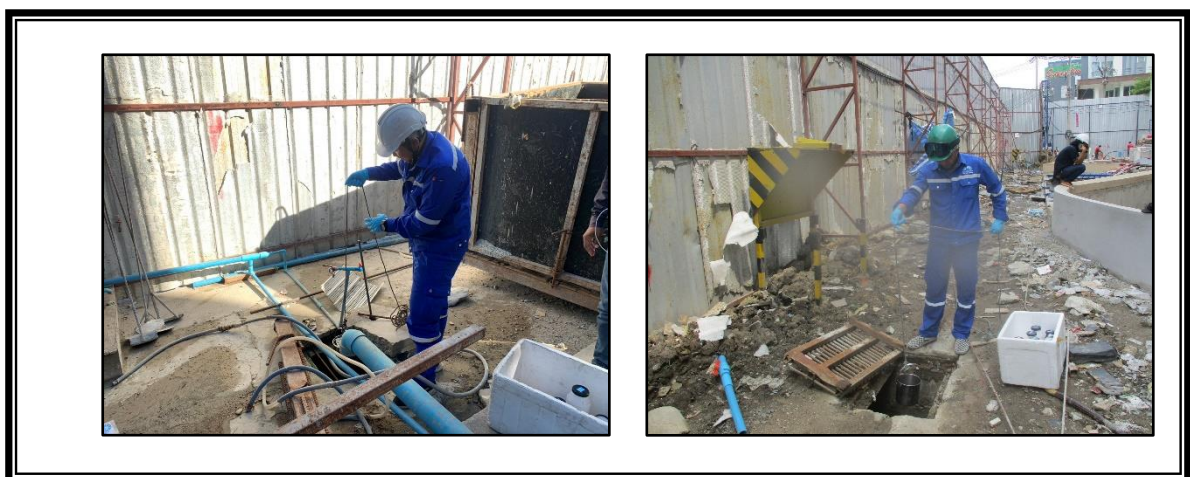
รูปที่ 3.4-1 จุดตรวจวัดคุณภาพน้ำทิ้ง บริเวณบ่อพักน้ำสุดท้ายของระบบระบายน้ำของโครงการ ก่อนระบายสู่ท่อด้านหน้าโครงการ
